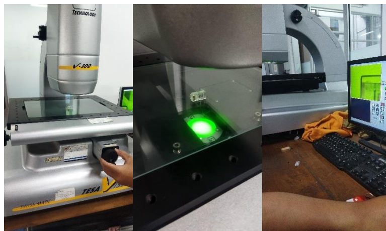
Gambar 1. 3 Pengukuran RJ45 menggunakan VMM .
