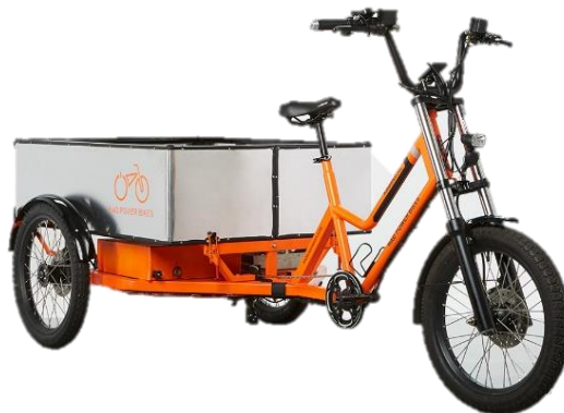
Gambar 1.6 RadBurro Electric Cargo Trike dengan konfigurasi delta trike Sumber: ( https://www.radpowerbikes.com , 2007)
