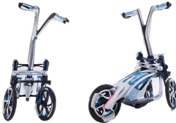
Gambar 1.5 Yamaha Tritown dengan konfigurasi tadpole trike (reverse trike) Sumber: ( https://global.yamaha-motor.com , 2017)
