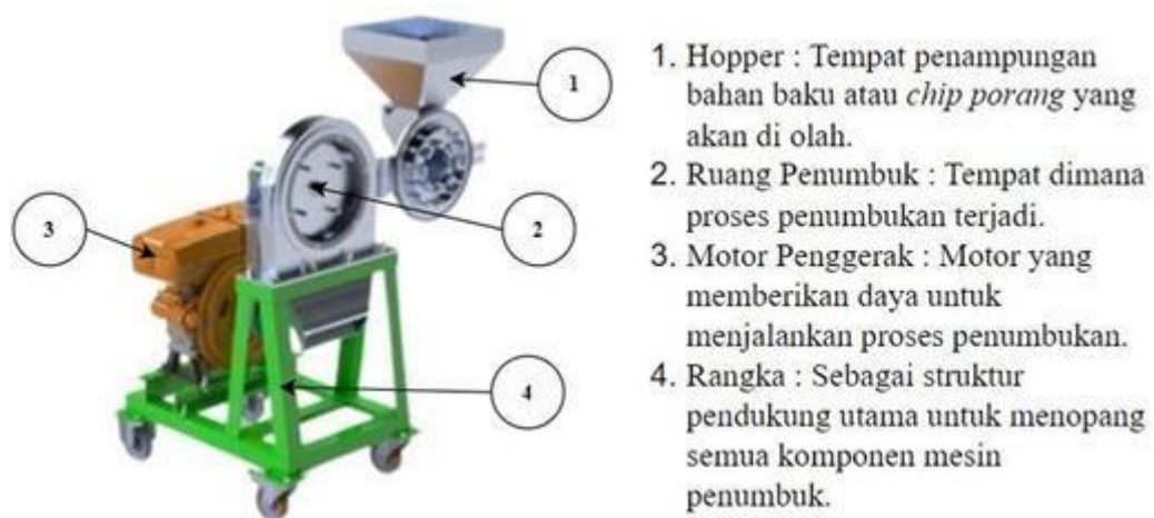
Gambar II-3 Mesin Disc Mill
