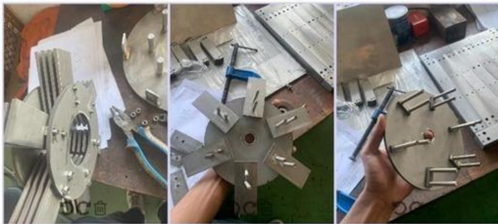
Gambar IV-14 Pemasangan Hammer Mill
