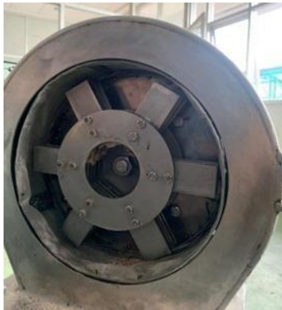
Gambar IV-15 Pemasangan Hammer Mill
