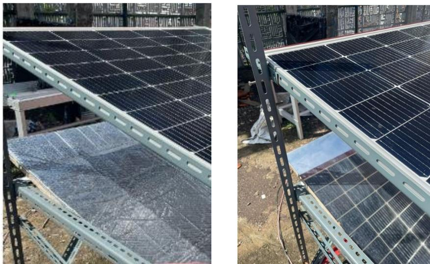
Gambar 3. 18 Penempatan reflektor (a. Aluminium foil; b. Cermin datar)
