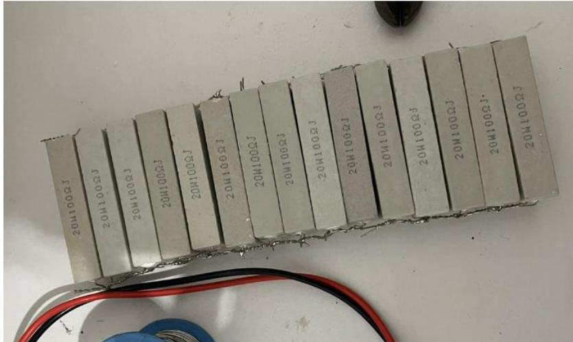
Gambar 3. 10 *Dummy load* 600 Watt yang digunakan
