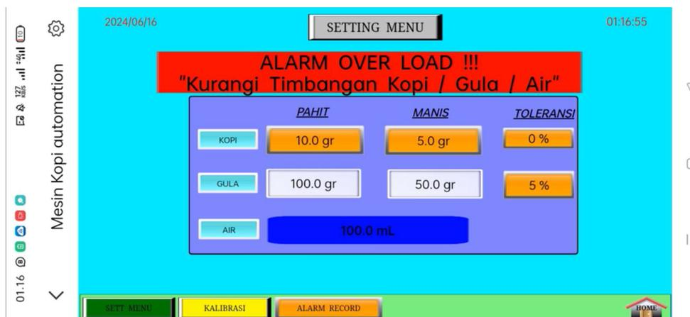
Gambar IV. 16 Tampilan Alarm Over Load
