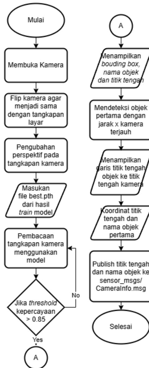
Gambar III.16 Diagram Alir Pendeteksian Objek
