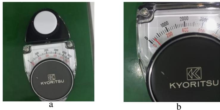
Gambar III.4 Pengukuran intensitas cahaya dengan lux meter (a) 260lux, (b)60lux
