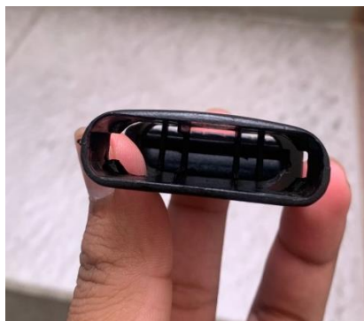
Gambar 1.7 Kontur bagian dalam female buckle
