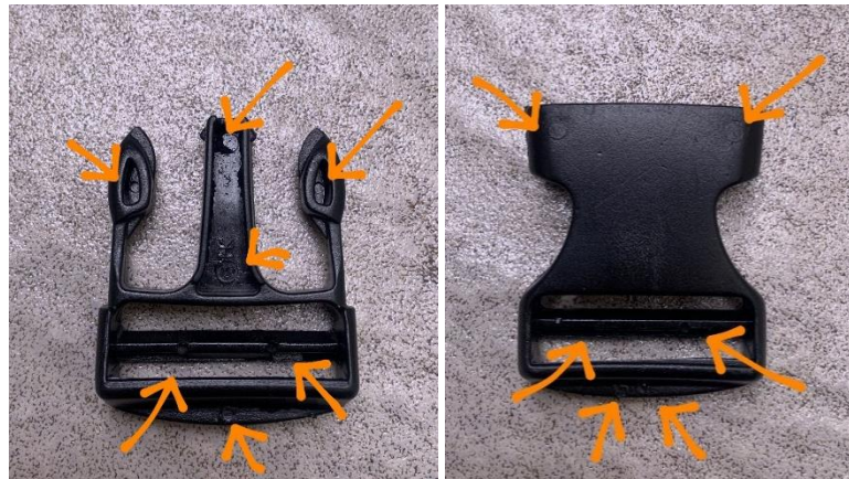
Gambar 1.6 Bekas pin ejector
