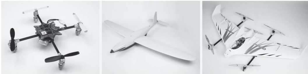
Gambar 1. 1 Tiga konfigurasi Drone yang umum yaitu sebuah multirotor (kiri), Fixed wing (tengah), dan Vertical takeoff landing (VTOL) (kanan).
