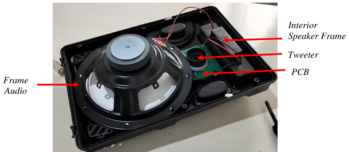
Gambar 1.1 Komponen Utama Pada Speaker
