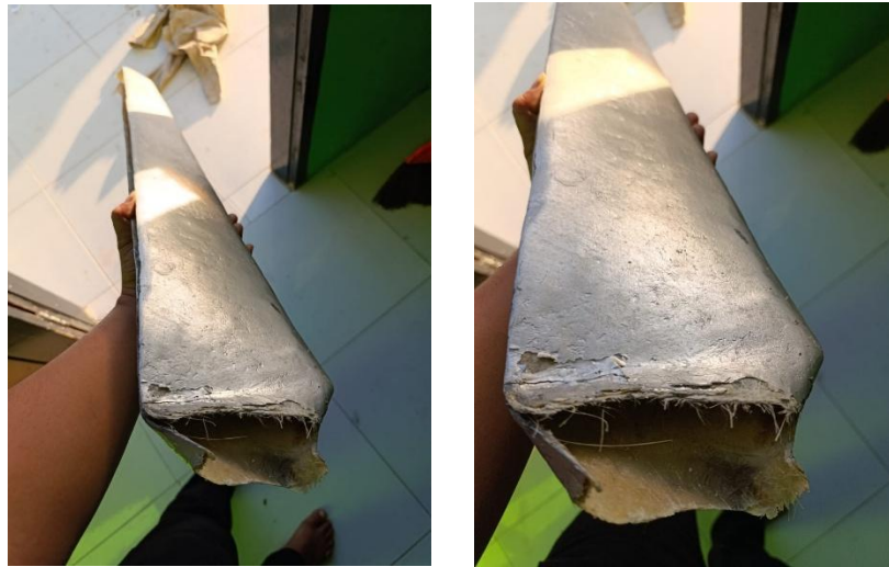
Gambar I. 1 kegagalan struktural pada bilah turbin angin
