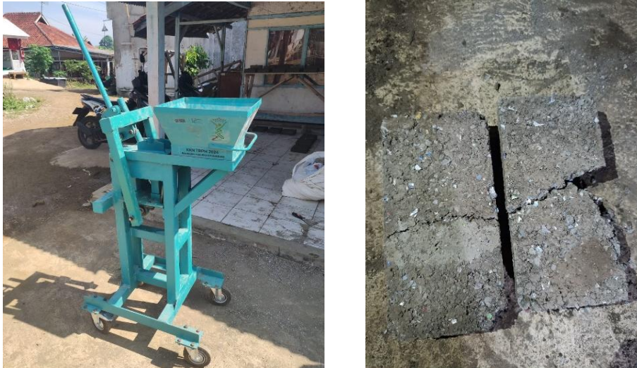
Gambar I.1 (a) Mesin press eco paving block , (b) retakan pada eco paving
