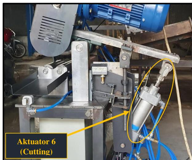
Gambar IV-10 Penempatan Aktuator 6.
