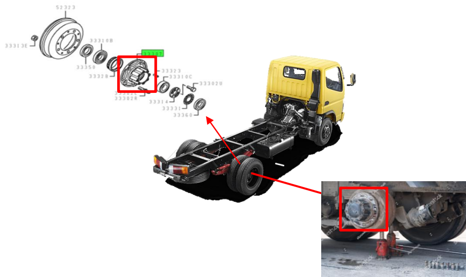
Gambar 1. 1 Skema Hub Wheel Rear Fe 84 dan posisinya pada truk
