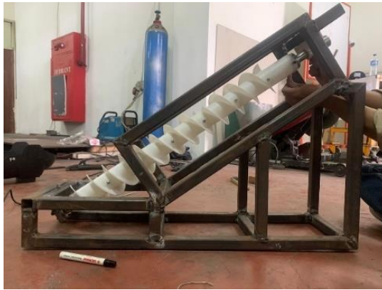
Gambar 2.46 Hasil Assembly Turbin Ulir
