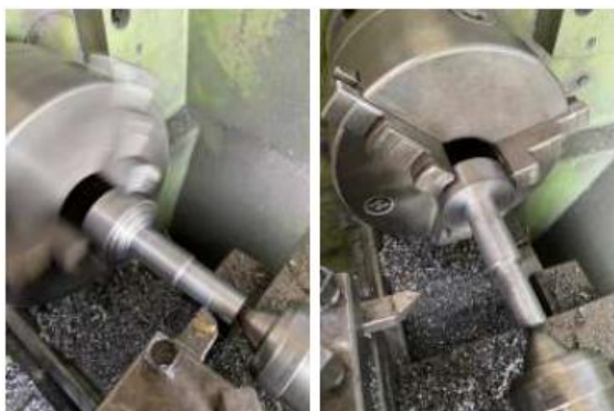
Gambar 2.37 Proses Pembubutan SMSB
