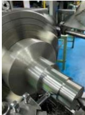
Gambar 2.40 Proses Pembubutan Poros bawah
