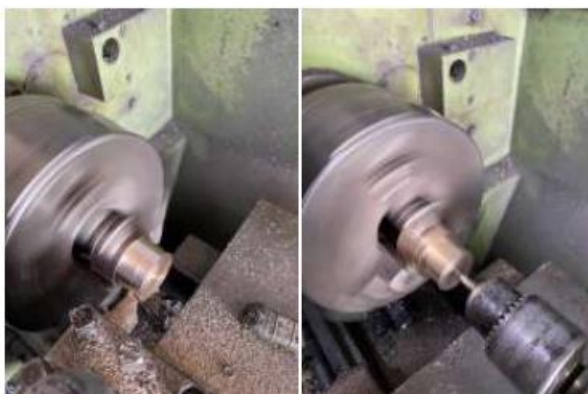
Gambar 2.38 Proses Pembubutan Bronze Bushing 1
