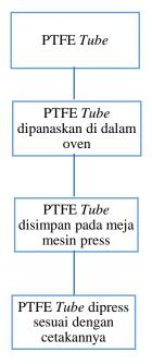
Gambar I.3 Proses Pembentukan PTFE Lining
