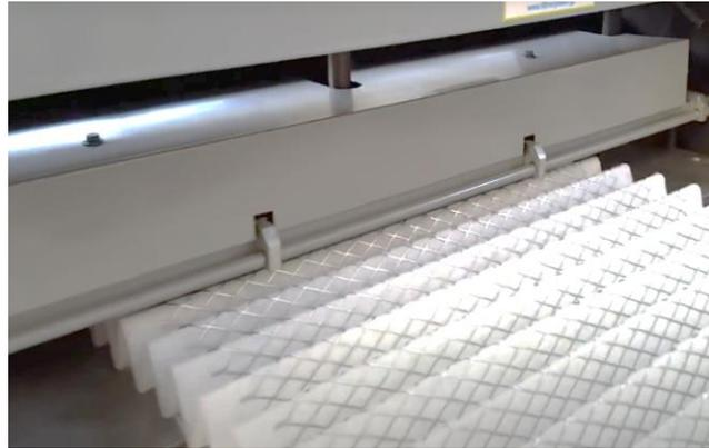
Gambar I. 2 Proses Penekukan *Filter*
