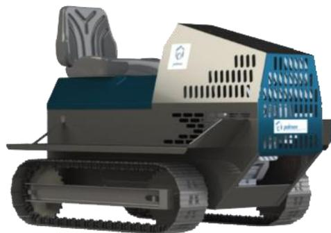
Gambar I- 3 Konsep *mini bulldozer* yang telah dikerjakan
