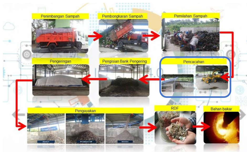
Gambar I.2 Alur Pengolahan Sampah di TPST Jeruklegi DLH Cilacap 2
