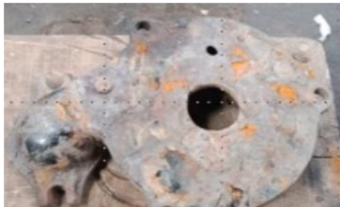
Gambar I.4 Cover pompa submersible dengan material lamellar cast iron .
