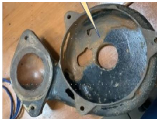
Gambar I.3 Cover pompa submersible standar mengalami kerusakan.
