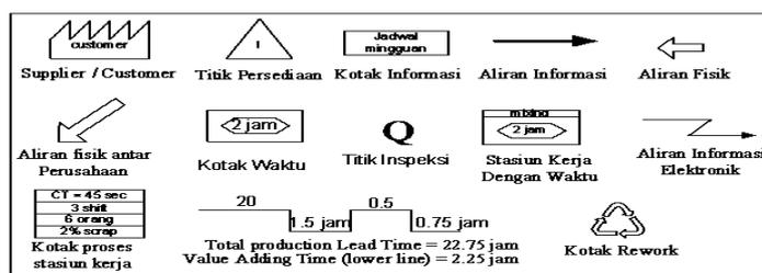
Gambar II. 1 Simbol-simbol dalam *Big Picture Mapping* [11]
