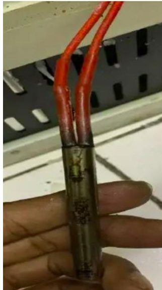
Gambar 1. 1 Kerusakan Heater oven yang menyebabkan downtime
